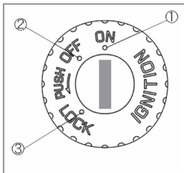
1. ON: Os circuitos elétricos estão ligados e o motor pode ser iniciado. A chave não pode ser retirada;
