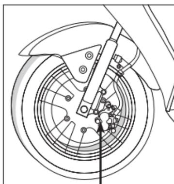
Os indicadores de desgaste das pastilhas de travão permitem verificar o desgaste sem desmontar o travão. Se o indicador quase tocar no disco do travão, entre em contacto com o seu concessionário para fazer a troca das pastilhas.
