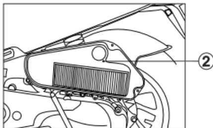
1. Retire os parafusos (1) e a tampa da caixa do filtro de ar.
