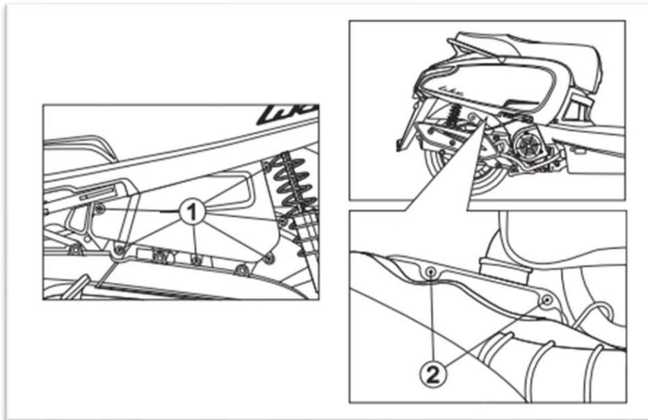
1. Retire os parafusos (1) da tampa da caixa do filtro de ar;
