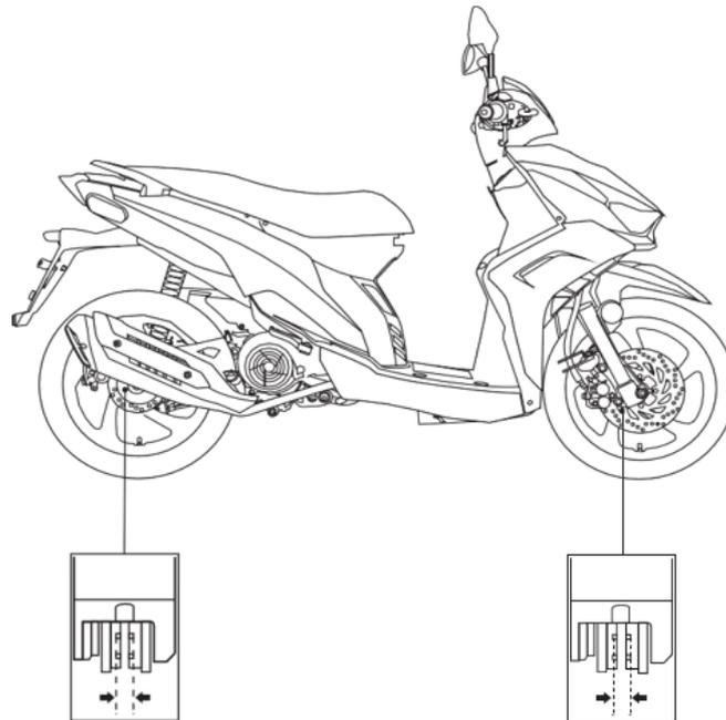
Os indicadores de desgaste das pastilhas de travão permitem verificar o desgaste sem desmontar o travão. Se o indicador quase tocar no disco do travão, entre em contacto com o seu concessionário para fazer a troca das pastilhas.
