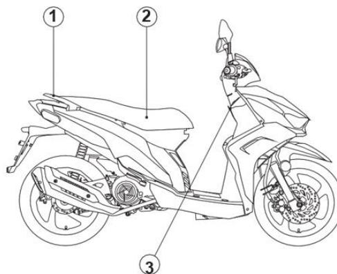
Existem 3 espaços no seu veículo destinados ao transporte de cargas. Respeite sempre o peso máximo e garanta que a carga não condiciona a visibilidade nem perturba a condução do veículo.
