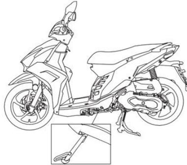
O descanso lateral pode ser utilizado quando o veículo está estacionado e possui um mecanismo de corte de corrente que impossibilita o funcionamento do motor. Pode verificar o bom funcionamento deste sistema de segurança ligando o motor e em seguida acionando o descanso lateral. Caso o motor não se desligue, deve contactar o seu concessionário Kymco de modo a verificar uma possível avaria.
