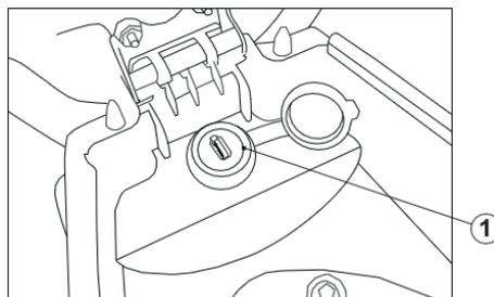
Este veículo está equipado com uma porta USB (1) que poderá ser utilizada para o carregamento de equipamentos móveis. Não deve utilizar a porta USB com o motor desligado, caso contrário poderá esgotar a bateria. Para utilizar a porta USB deverá:
