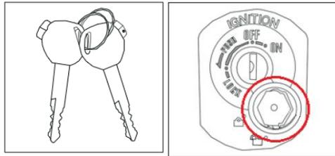
Na sua extremidade, as chaves apresentam uma saliência que permite bloquear e desbloquear o mecanismo de segurança do canhão.
