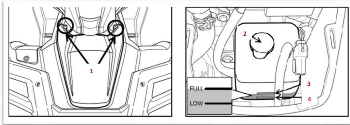
Uma vez que o nível do líquido de refrigeração altera conforme a temperatura do motor, este deve ser verificado após o seu arrefecimento.
