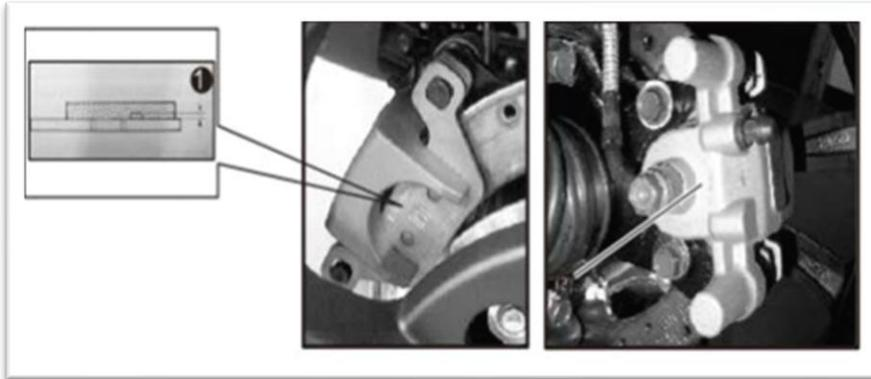
Verifique regularmente o desgaste das pastilhas de travão (1). Caso a espessura das pastilhas de travão seja igual ou inferior a 1.00 mm, devem ser substituídas por umas pastilhas novas. Entre em contacto com o seu concessionário sempre que for necessário fazer a troca das pastilhas.
