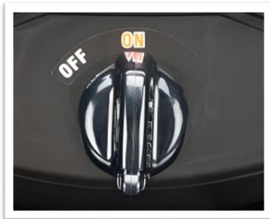
“OFF”: Rode a chave para esta posição para desligar o motor, todos os circuitos elétricos e retirar a chave.
