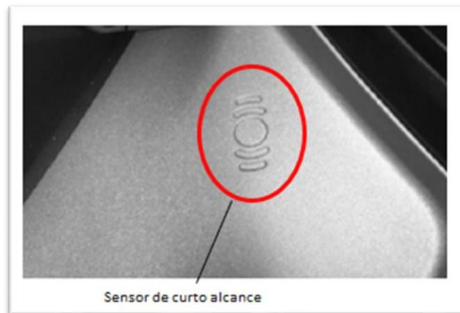
A tecnologia “Keyless” funciona através de ondas de rádio e o alcance poderá ser afetado pelos elementos em redor. O sensor tem um alcance de 3.5 metros, que podem ser afetados pelo estado da bateria, ruídos electromagnéticos, ondas de rádio, obstáculos metálicos, entre outros. A distância ideal de funcionamento, são os 1.5 metros em relação ao centro do veículo.
